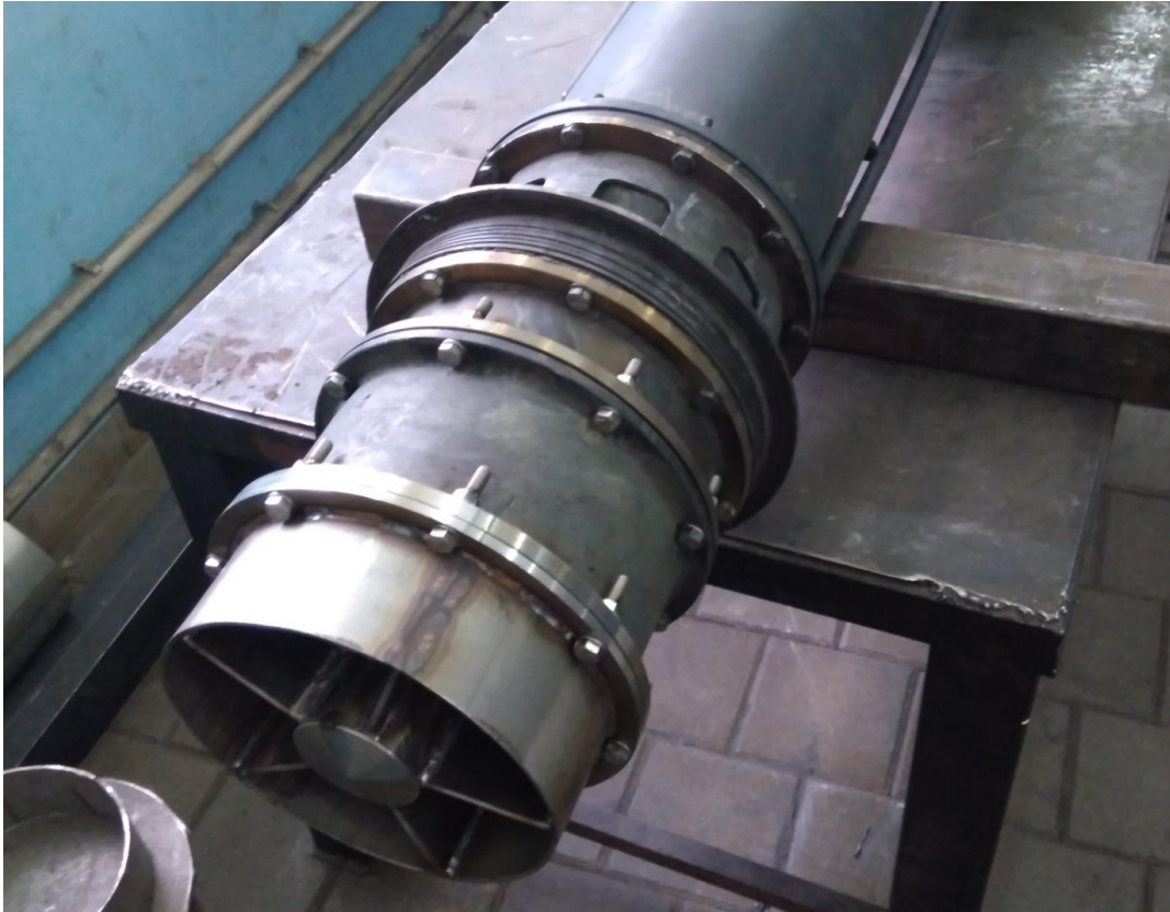
Рис. 2. Общий вид участка выемной части насоса НСО-02НГТУ с закрепленным устройством закрутки потока свинца на подводе к насосу
