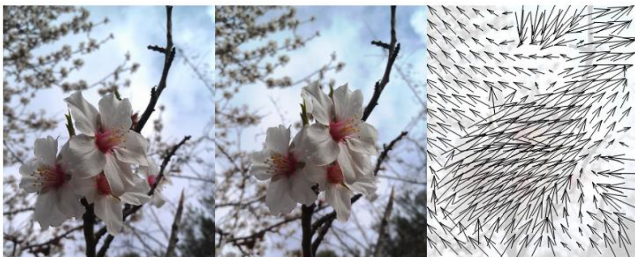
Рис. 1. Два последующих кадра и векторное поле перемещений
