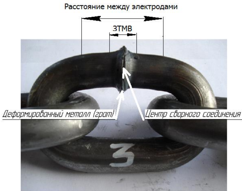
Рис. 6. Сваренное звено цепи 20x80 без обрезки грата
