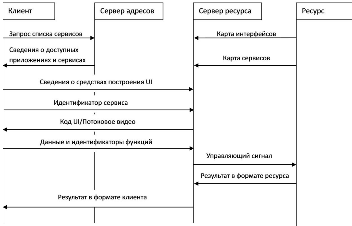
Рис. 1. Схема передачи управляющих сигналов и данных
