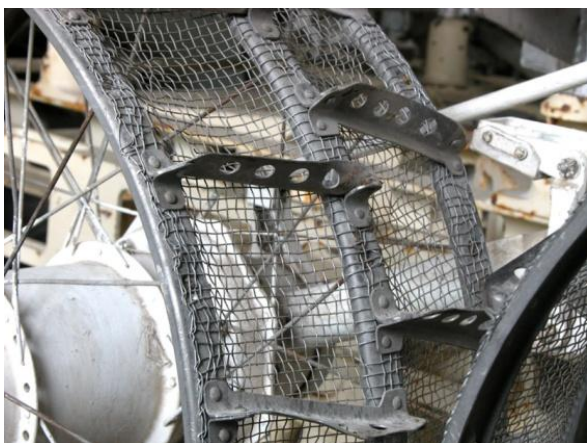
Рис. 8. Колесо лунохода (1970 г.)
