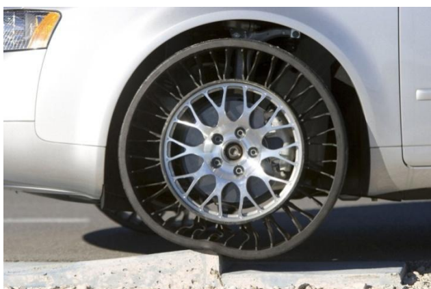
Рис. 13. Шины Michelin Tweel (2004 г.)
