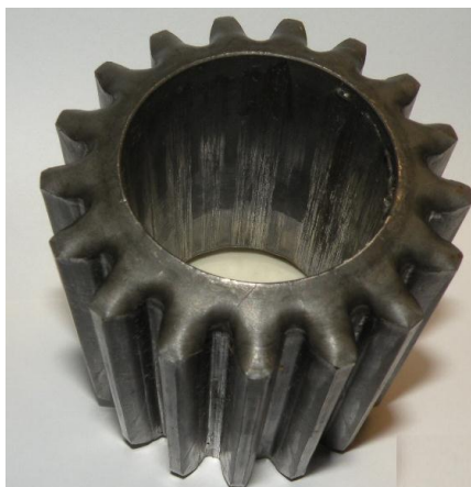
Рис. 6. Сателлит, изготовленный методом холодной объемной штамповки (сталь 20ХГНМТА)
