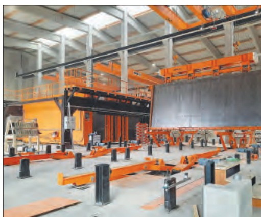
Кассетная установка и опалубка «Бабочка» сочетают в себе преимущества горизонтальной подготовки и вертикального производства The cassette installation and the "Butterfly" formwork combine the advantages of horizontal preparation and vertical production
