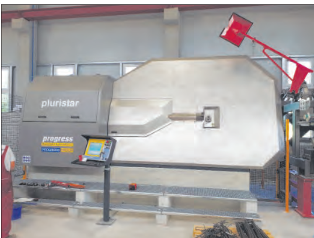
Многофункциональный станок Pluristar может автоматически переключаться между режимами сдвоенной обработки и одиночной обработки прутков и автоматически регулировать норматив The Pluristar multifunctional machine can automatically switch between the modes of double processing and single processing of bars and automatically adjust the standard
