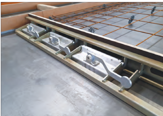
Опалубка MultiForm с магнитами MagFly® MultiForm formwork with MagFly® magnets
