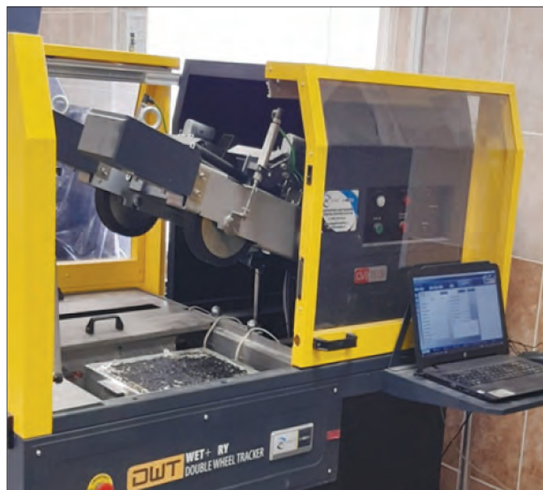
Рис. 7. Испытания на колеобразование (машина DWT 78-PV33B05)
