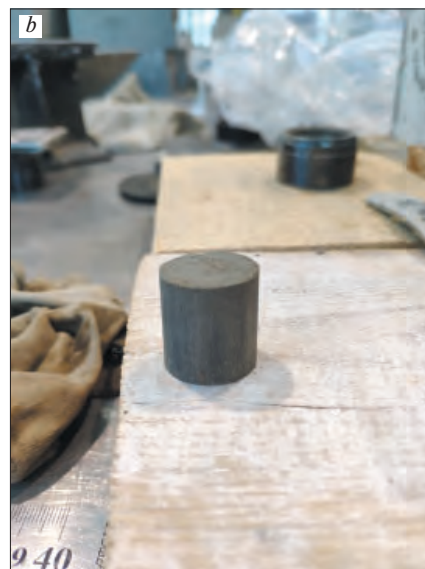
Рис. 2. Фильтрационное прессование цилиндрических образцов: a – процесс фильтрационного прессования; b – образец-цилиндр, изготовленный по технологии фильтрационного прессования
