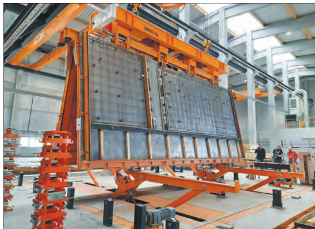
Плавное складывание опалубки с помощью специального гидравлического оборудования Smooth folding of the formwork using special hydraulic equipment
