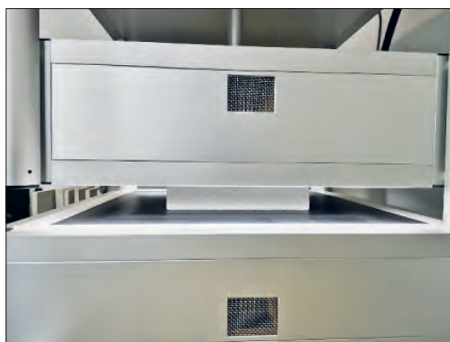
Рис. 1. Испытания теплопроводности образцов АЯБ на приборе Lambda-Meter EP500e Fig. 1. Thermal conductivity tests of aerated concrete samples on the Lambda-Meter EP500e device
