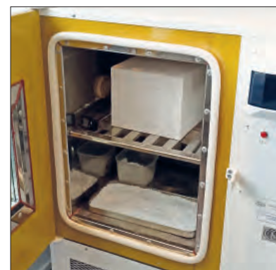
Рис. 2. Кондиционирование образцов АЯБ в камере с влагопоглотителем Fig. 2. Conditioning of autoclaved aerated concrete samples in a chamber with a desiccant
