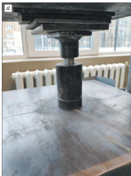
Рис. 2. Фильтрационное прессование цилиндрических образцов: a – процесс фильтрационного прессования; b – образец-цилиндр, изготовленный по технологии фильтрационного прессования
