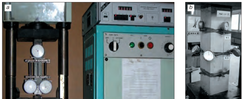
Рис. 3. Общий вид испытаний образца на центральное сжатие (определение модуля упругости): а – испытание призм 40×40×160 мм на прессе ИП-100; б – испытание призм 150×150×600 мм на прессе ИП-2000 Fig. 3. General view of the sample tests for central compression (determination of the modulus of elasticity): а – testing of prisms 40×40×160 mm on the IP-100 press; б – testing of prisms 150×150×600 mm on the IP-2000 press
